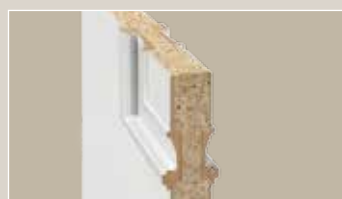
Listwa profilowa w zagłębieniu płyty drzwiowej
