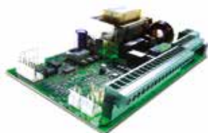
Centrala sterująca słupka JE275 Steruje maks. 3 słupkami typu J275 HA
